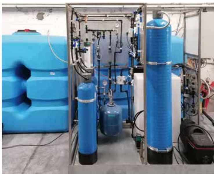
De proefinstallatie voor de drinkwaterproductie bij 't Hof Bellewaerde, een samenwerking tussen De Watergroep en BOSAQ. (Foto: De Watergroep)
