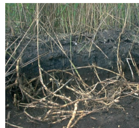
► Zicht op de doorsnede van het ontwaterd slib met de wortels van de rietplanten (rhizomen)
